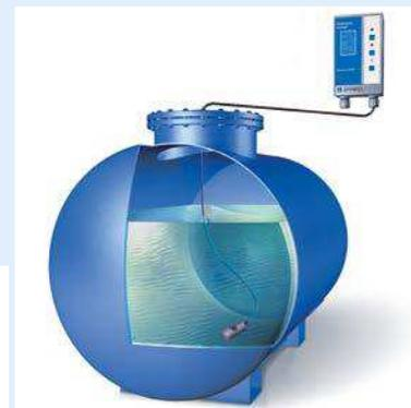
**Anwendung** Ortsunabhängige Füllstandmessung mit digitaler Anzeige und Meldung eines Minimalfüllstandes (Reservemeldung) im Rahmen eines Messvorganges. Geeignet für Behälter bis max. 400 cm Füllhöhe. Für Heizöl EL, L oder Dieseldieselkraftstoff, FAME 100 % als Biodiesel (EN 14214) und Wasser (kein Trinkwasser!). Zudem kann DTA 10 variabel zur Füllstandmessung für alle nicht aggressiven Flüssigkeiten mit einer Dichte von 0,5 bis 1,5 g/cm<sup>3</sup> eingesetzt werden. Fernmessung bis 15 m.
