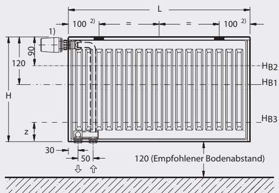
HB1 = Höhe Bohrloch oben Konsole BMSplus FMS/FMX
