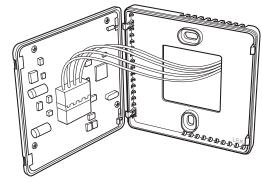
Gehäuseoberteil auf Gehäuseuntertel drücken und die beiden Klammern auf der anderen Seite des Gehäuseunterteils in die entsprechenden Spalten des Gehäuseoberteils einrasten lassen.
