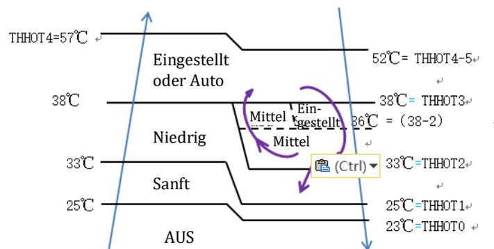
\* Restwärme-Abgabe. Der Innengerät-Ventilator gibt die Restwärme für 20 Sekunden mit niedriger Geschwindigkeit ab.
