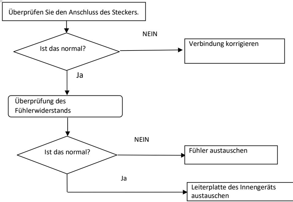
Methode zur Überprüfung des Fühlerwiderstands:
