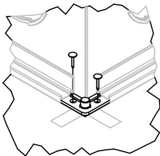
3. Anschlüsse montieren bzw. verschließen - Achten Sie darauf, dass vor dem Betonieren alle Anschlüsse belegt oder bei nicht benötigten Anschlüssen je ein Deckel eingesetzt wird.
