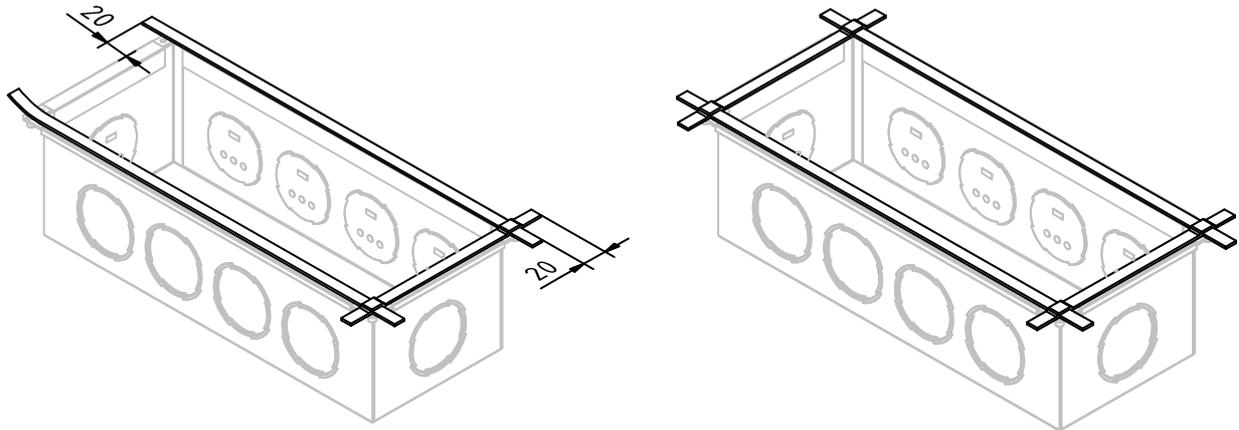
2. Verteiler 10-fach auf Schalung befestigen - Befestigung kann mittels kleiner Nägel an den jeweils vorgefertigten Löchern in den Ecken (4x) erfolgen.
