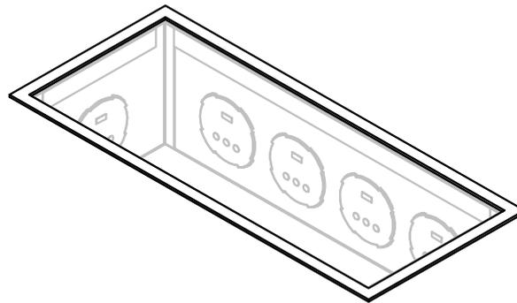
Montieren Sie den Deckel mit dem im Lieferumfang enthaltenen Schrauben/Scheiben (Pos. 3). Bei Bedarf schrauben Sie den Deckel zusätzlich mittig mit den im Lieferumfang enthaltenen Schrauben (Pos. 4) zur besseren Fixierung fest.
