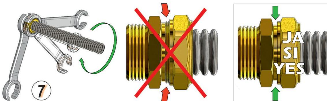
Mit geeignetem Werkzeug zudrehen bis **kein Gewinde mehr sichtbar** ist.
