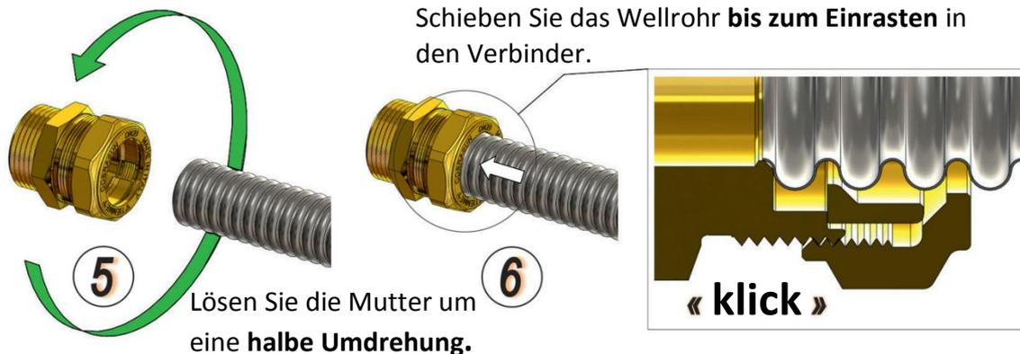
Lösen Sie die Mutter um eine **halbe Umdrehung**.
