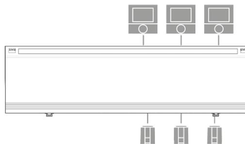
Die Kreise werden nicht gleichzeitig mit Wärme versorgt. Diese Funktionsweise findet nur bei trägen Heizsystemen wie Flächenheizungen Anwendung.
