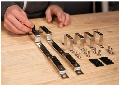
1. Jeweils zwei Entkopplungsgummis auf der Vorderseite in die dafür vorgesehenen Bohrungen in Halteschienen einlegen.
