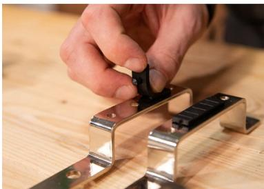
2. Entkopplungsgummis in Innenseite der Haltebügel einlegen.
