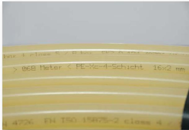
Bitte vermeiden Sie unbedingt Knickstellen im Rohr. Sollten bei der Verlegung dennoch welche entstehen, so müssen diese entfernt werden. Der Mindestbiegeradius beträgt  $5 \times D$  ( $D$  = Durchmesser des Heizrohrs).
