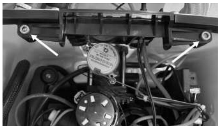
Abb. 9: Schrauben des schwarzen Einsatzes lösen
