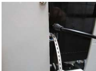
Abb. 10: Grauen Verschluss entfernen und LAN-Kabel durch Öffnung führen
