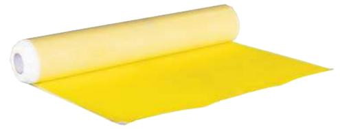
Die Entkoppelungsmatte ist multifunktional, selbstklebend und mit neuester Bi-Compound-Technologie hergestellt. Mit der geringen Aufbauhöhe und optimaler Entkoppelungsleistung ist sie für hohe Belastungsbereiche einsetzbar. Die unterseitige Spezialklebebeschichtung verbessert die Trittschallwerte zusätzlich. Die Verlegegeschwindigkeit ist dank der selbstklebenden Unterseite um ein Vielfaches schneller als bei herkömmlichen Entkoppelungsmatten, die mit Fliesenkleber verklebt werden.
