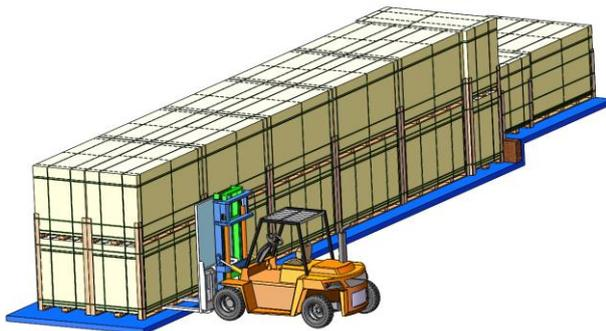
Entladen von Verpackungen im Querformat mit Gabelstapler
