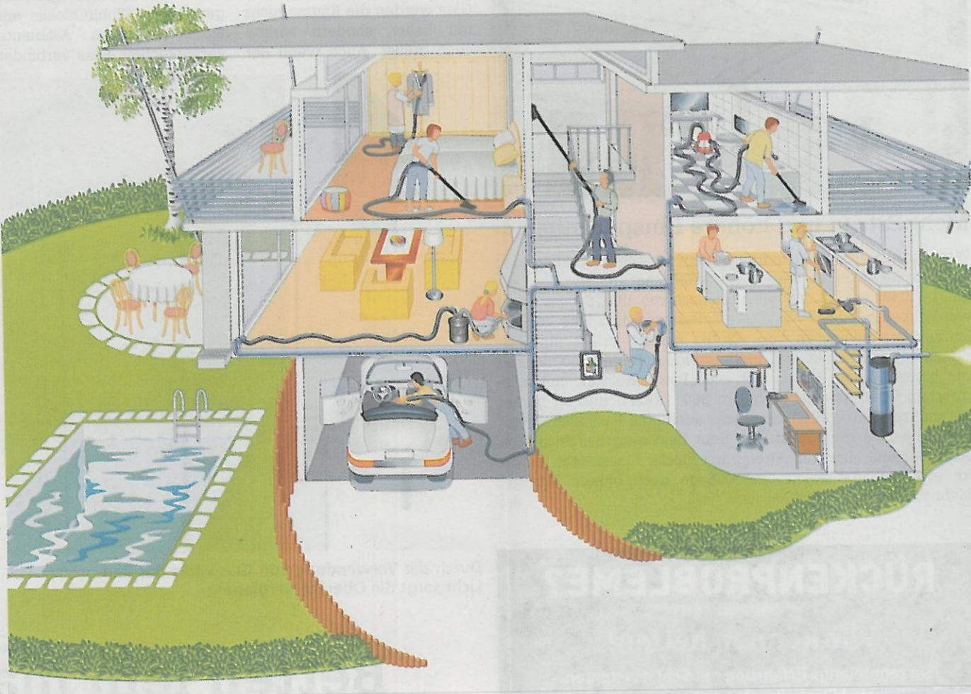
Saugschlauch im jeweiligen Raum mit der Bodendüse angeschlossen wird, werden durch ein Rohrleitungsnetz mit dem Zentralgerät verbunden.
