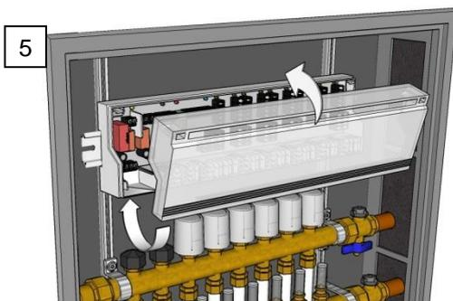
5 Den Deckel schließen und die Netzspannung herstellen. Die Basis ist jetzt einsatzbereit.
