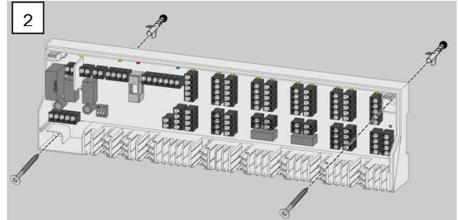
Die beiden Befestigungslöcher für die Basis markieren und herstellen. Darauf achten, dass die Basis waagrecht ausgerichtet ist. Abhängig von der Wandbeschaffenheit, die Basis mit Dübeln und Schrauben (2 Stück 4 mm) montieren.
