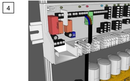
4 Kabel durch die Zugentlastung ins Gehäuse führen und die Basis mit Hilfe der Klemm-/Stecktechnik innerhalb kürzester Zeit verdrahten.
