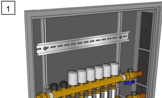
1 Eine Hutschiene aufputz oder im Heizkreisverteilerschrank montieren oder eine vorhandene nutzen.
