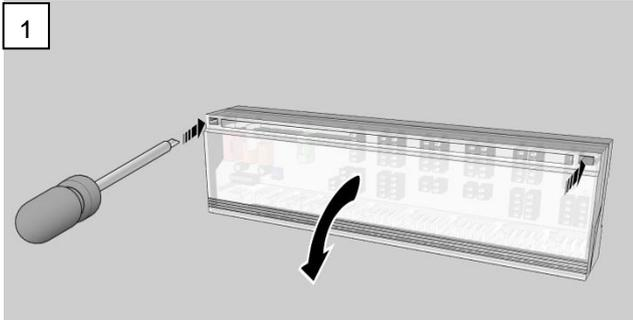
Die Gehäuseabdeckung an den beiden Verriegelungspunkten mit einem Schraubendreher lösen und abnehmen.
