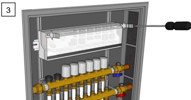
3 Die Gehäuseabdeckung an den beiden Verriegelungspunkten mit einem Schraubendreher lösen und abnehmen.
