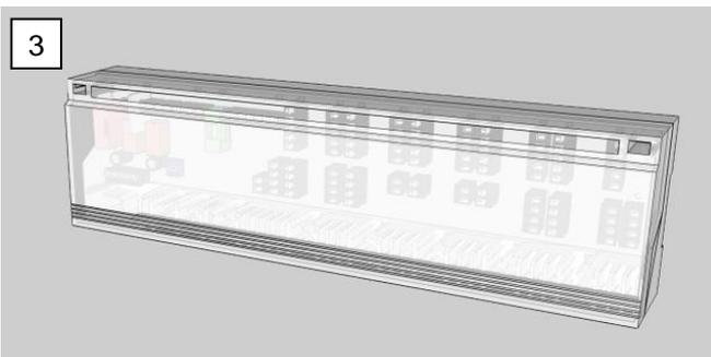
Die Basis ausrichten und die Schrauben handfest anziehen. Die Kabel durch die Zugentlastung ins Gehäuse führen und die Basis mit Hilfe der Klemm-/Stecktechnik innerhalb kürzester Zeit verdrahten. Den Deckel schließen und die Netzspannung herstellen. Die Basis ist jetzt einsatzbereit.
