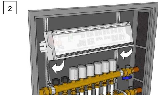
2 Basis leicht gekippt auf die Hutschiene aufsetzen und einrasten lassen.
