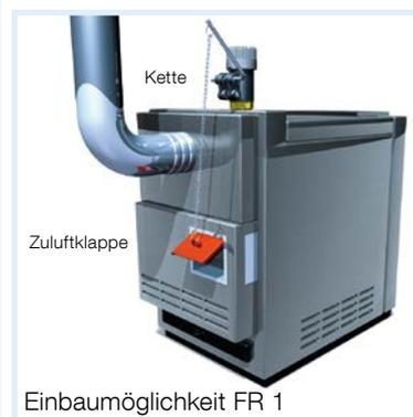
Der Feuerungsregler FR 1 regelt die Luftzufuhr für die Verbrennung. Die Temperatur im Wärmeerzeuger wird über einen integrierten Thermostaten erfasst. Der Thermostat ist über eine Hebelstange und eine Kette mit der Zuluftklappe verbunden. In Abhängigkeit von der Kesselvorlauftemperatur wird die Luftzufuhr durch Öffnen oder Schließen der Zuluftklappe geregelt.
