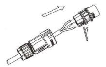
• Drücken Sie die Gewindehülse in die Buchse, ziehen Sie die Kappe auf der Klemme fest.
