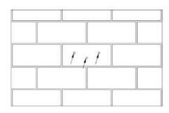
• Stecken Sie die Dehnungsrohre in die Löcher und ziehen Sie sie fest. Montieren Sie die Halterung mit den Dehnschrauben.
