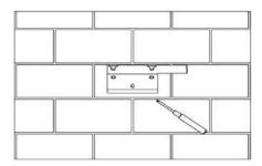
• Bohren Sie die Löcher mit einer elektrischen Bohrmaschine, stellen Sie sicher, dass die Löcher mindestens 50 mm tief sind, und ziehen Sie dann die Dehnungsrohre fest.
