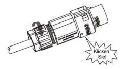
• Drücken Sie die Gewindehülse auf die Anschlussklemme, bis beide fest am Wechselrichter eingerastet sind.
