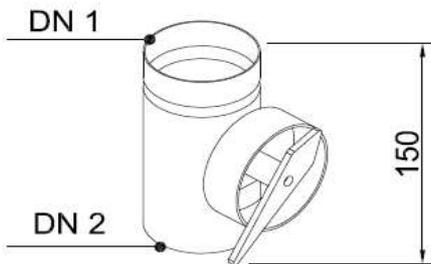
Verteilerregelklappe mit Bundkragen
