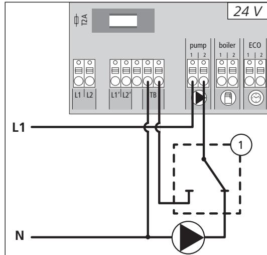
Raccordement d'un limiteur de température de sécurité mis à disposition par le client (1). Ce limiteur arrête la pompe et active l'entrée TB dès que l'appareil détecte que les températures montantes du sol chauffant sont trop élevées. Dès activation de l'entrée TB, la station de base arrête automatiquement tous les actionneurs.
