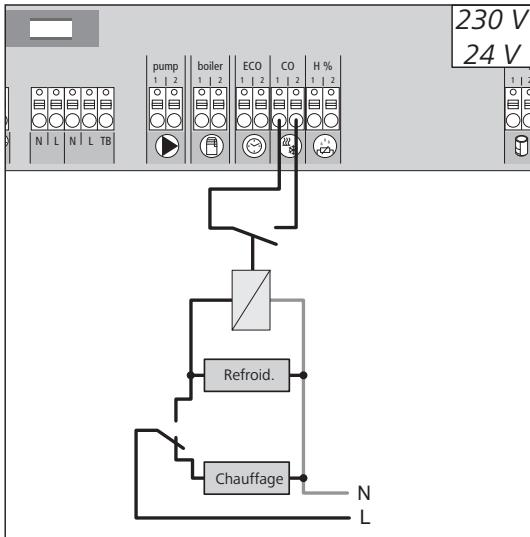
En cas d'utilisation d'un signal change-over externe, l'ensemble de l'installation bascule entre chauffage et refroidissement en fonction de ce signal.
