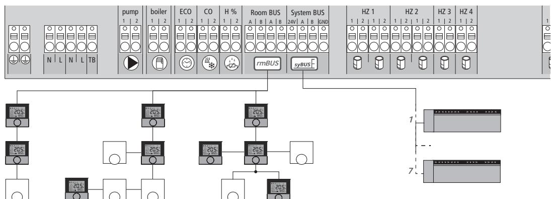
Aan de Room Bus kunnen per basisstationstype max. vier, acht of twaalf kamerbedieningstoestellen aangesloten worden. De aansluiting van de kamerbedieningstoestellen kan in de topologieën Lijn, Boom en Ster gebeuren. Via de System Bus kunnen maximaal zeven basisstations gekoppeld worden. Voor de bekabeling dient een massieve kabel 2x2x08 gebruikt te worden. Bij een leidingsdiameter <6 mm dient de trekontlasting door de opdrachtgever voorzien te worden.
