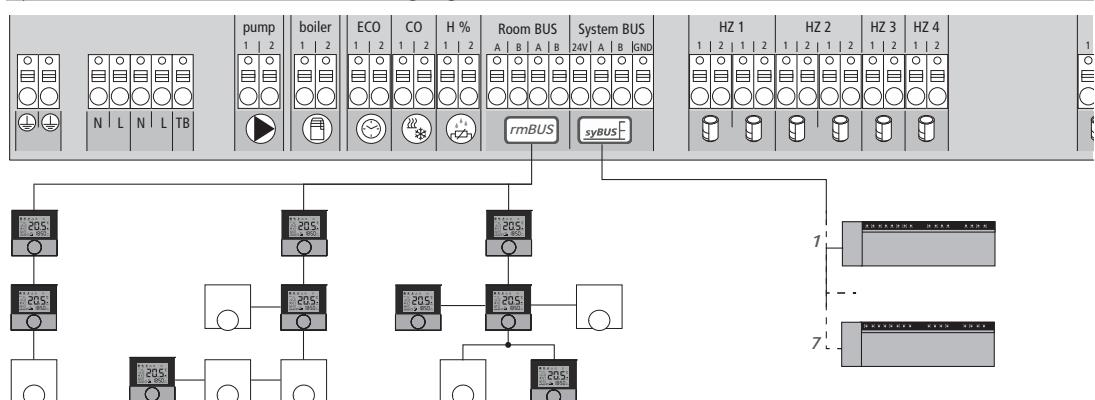
Al Room Bus se pueden conectar, dependiendo del tipo de estación base, máx. cuatro, ocho o doce unidades de control de habitación. La conexión de las unidades de control de habitación puede realizarse en las topologías línea, árbol y estrella. Se pueden acoplar máximo siete estaciones base a través del System Bus. Para el cableado se tiene que emplea un cable masivo 2x2x08. En caso de un diámetro de línea <6 mm la descarga de tracción ha de ser suministrada por el cliente.
