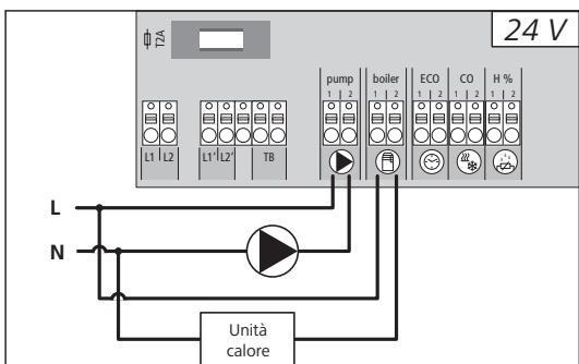
Il collegamento per il boiler (caldaia) permette il comando di un'unità di produzione del calore. Inoltre può essere comandata direttamente una pompa.
