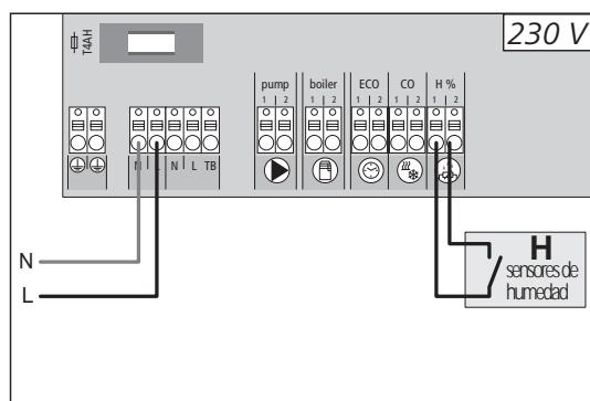
Los sensores de humedad que se han puesto a disposición ya de fábrica, sirven como protección en el modo de enfriamiento.
