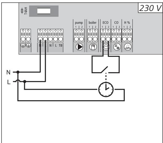
**DEU** Staat geen extern Change Over-signal ter beschikking, kan de interne Pilot-functie van het basisstation voor de omschakeling van de volledige installatie tussen de bedrijfsmodi verwarmen en koelen gebruikt worden. Hierbij wordt een door het basisstation voor de omschakeling gebruikt relais gebruikt.
