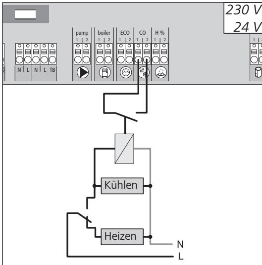
Bei Nutzung eines externen Change Over Signals schaltet die Gesamtanlage entsprechend dieses Signals zwischen Heizen und Kühlen um.
