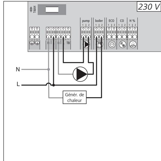
Le connecteur Boiler (chaudi  re) permet la commande d'un g  n  rateur de chaleur. De plus, il est possible d'alimenter et de commander directement une pompe.
