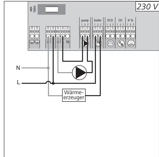
Der Anschluss Boiler (Kessel) ermöglicht die Steuerung eines Wärmeerzeugers. Zusätzlich kann eine Pumpe direkt versorgt und gesteuert werden.
