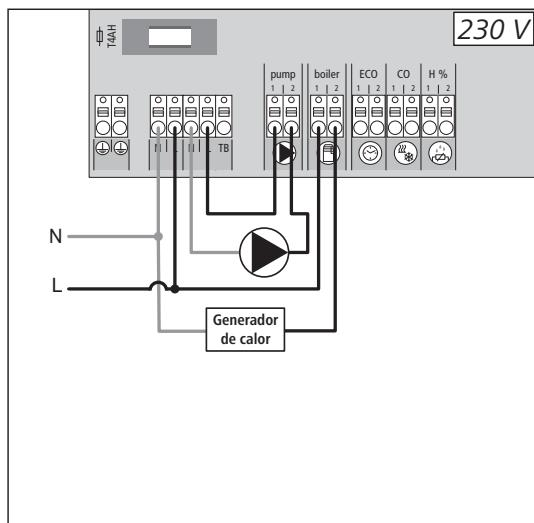
La conexión de la caldera permite el mando de un generador de calor. Además se puede alimentar y manejar directamente una bomba.
