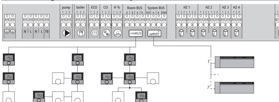
Al Room Bus possono essere collegati un massimo di quattro, otto o dodici unità di controllo ambientale, a seconda del tipo di stazione di base. Il collegamento delle unità di controllo ambientale può avvenire nelle tipologie linea, albero e stella. Tramite il System Bus possono essere accoppiate al massimo sette stazioni di base. Per il cablaggio deve essere utilizzato un conduttore pieno del tipo 2x2x08. Se il conduttore ha un diametro < 6 mm, la trazione deve essere scaricata in loco.
