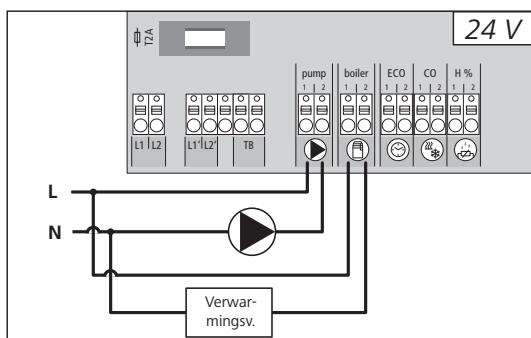
De aansluiting boiler (ketel) maakt de stuuring van een verwarmingstoestel mogelijk. Bijkomend kan een pomp direct gestuurd worden.
