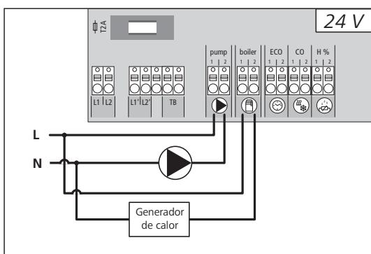
La conexión de la caldera permite el mando de un generador de calor. Además se puede manejar directamente una bomba.
