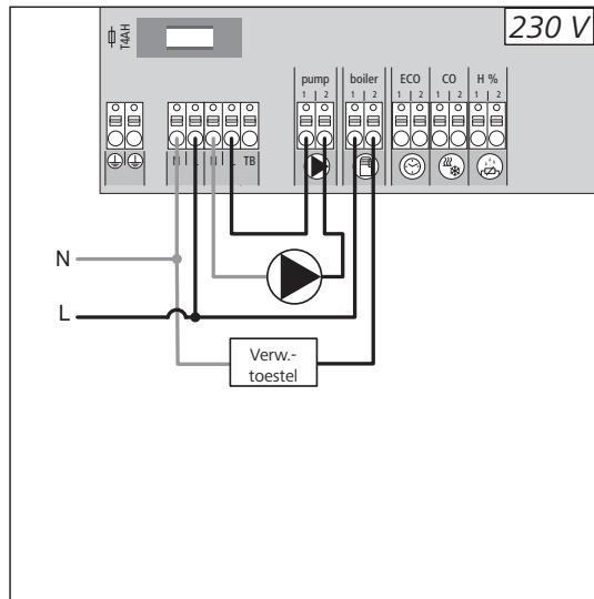
De aansluiting boiler (ketel) maakt de stuuring van een verwarmingstoestel mogelijk. Bijkomend kan een pomp direct gevoed en gestuurd worden.
