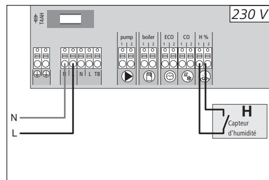
En mode refroidissement, les capteurs d'humidit   fournis par le client prot  gent de la ros  e.
