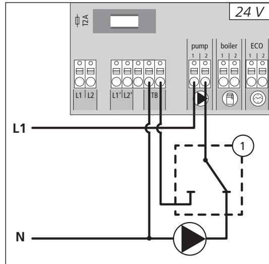
Aansluiting van een door de opdrachtgever voorziene veiligheidstemperatuurbegrenzer (1). Deze schakelt de pomp uit en schakelt de ingang TB in, wanneer te hoge voorlooptemperaturen van de vloerverwarming herkend worden. Wordt de TB-ingang ingeschakeld, rijdt het basisstation alle aandrijvingen automatisch dicht.
