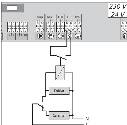
Si se utiliza una señal externa de conmutación, la instalación en su conjunto conmuta dicha señal entre calefacción y enfriamiento, según corresponda.
