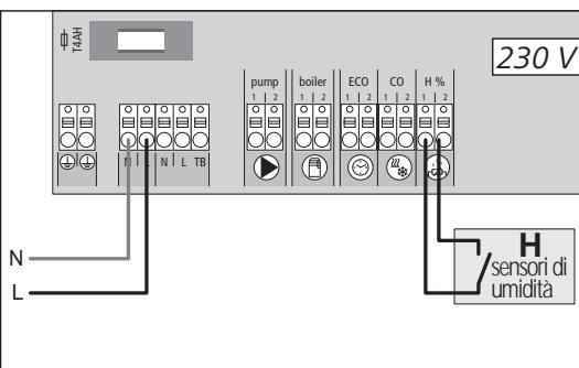
I sensori di umidità, a carico del committente, servono per evitare la formazione di rugiada in modo di raffreddamento.
