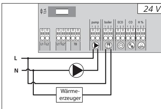
Der Anschluss Boiler (Kessel) ermöglicht die Steuerung eines Wärmeerzeugers. Zusätzlich kann eine Pumpe gesteuert werden.
