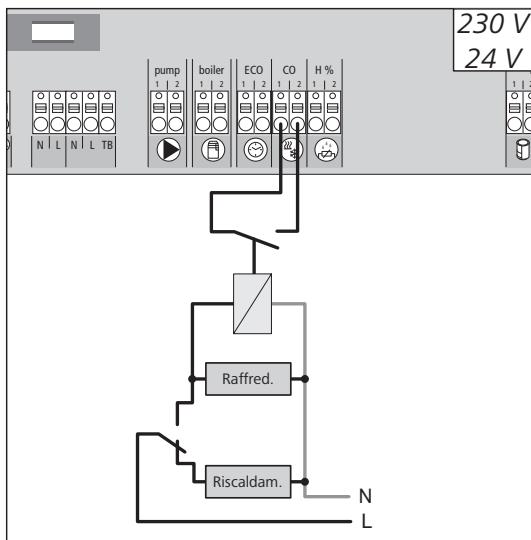
Se si utilizza un Change Over Signal esterno, l'intero impianto commuta da riscaldamento a raffreddamento e viceversa in base a questo segnale.
