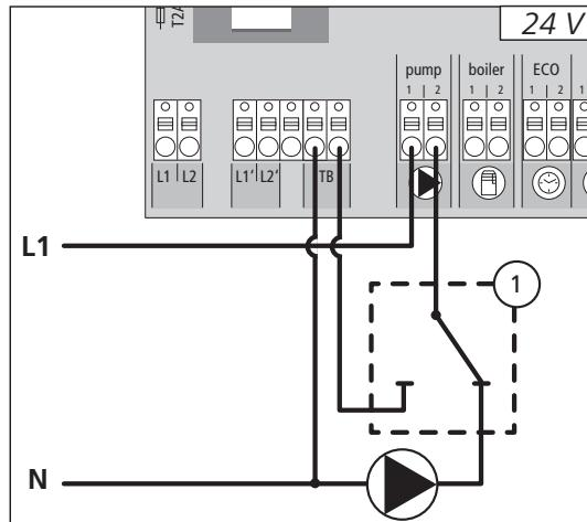
Anschluss eines bauseitig bereitgestellten Sicherheitstemperaturbegrenzers (1). Dieser schaltet die Pumpe aus und schaltet den Eingang TB, wenn zu hohe Vorlauftemperaturen der Fußbodenheizung erkannt werden. Wird der TB-Eingang geschaltet fährt die Basisstation alle Antriebe automatisch zu.
