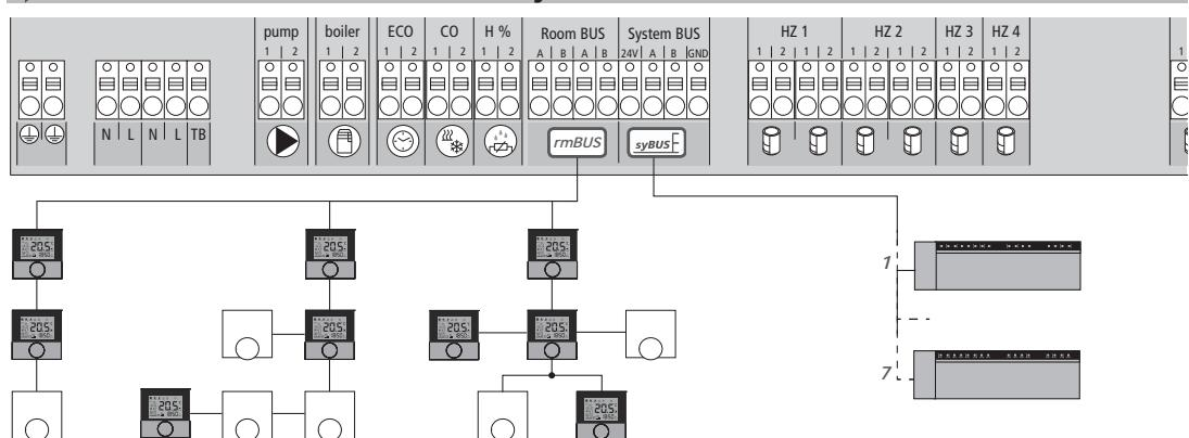
An dem Room Bus können je nach Basisstationstyp max. vier, acht oder zwölf Raumbediengeräte angeschlossen werden. Der Anschluss der Raumbediengeräte ist verpolungssicher und kann in den Topologien Linie, Baum und Stern erfolgen. Für die Verdrahtung ist eine Installationsleitung 2x2x0,8 zu verwenden. Über den System Bus können max. sieben Basisstationen gekoppelt werden. Bei einem Leitungsdurchmesser <6 mm ist die Zugentlastung bauseits vorzusehen.
