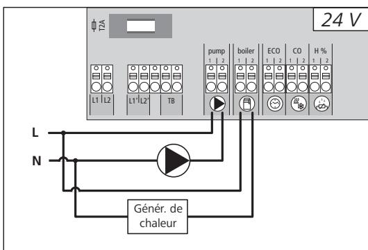
Le connecteur Boiler (chaudi  re) permet la commande d'un g  n  rateur de chaleur. De plus, il est possible et de commander directement une pompe.
