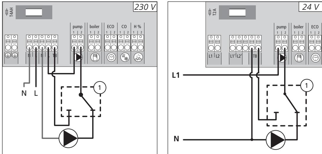
Collegamento per un limitatore di temperatura di sicurezza messo a disposizione dal cliente (1). Questo disattiva la pompa e abilita l'ingresso TB allorquando vengano riconosciute temperature di mandata troppo elevate nel riscaldamento a pavimento. Quando l'ingresso TB viene attivato, la stazione di base aziona automaticamente tutti gli attuatori.
