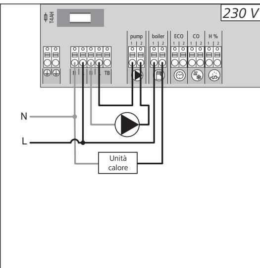
Il collegamento per il boiler (caldaia) permette il comando di un'unità di produzione del calore. Inoltre può essere alimentata e comandata direttamente una pompa.
