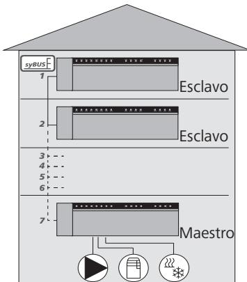
El acoplamiento de las estaciones base se realiza de la siguiente forma:
