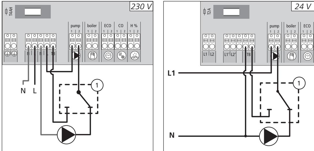
Conexión de un limitador de temperatura de seguridad dispuesto por el cliente (1). Esto desactiva la bomba y conecta la entrada TB cuando se registran temperaturas iniciales demasiado altas en la calefacción de suelo. Si se activa la entrada TB, la estación de base conduce todos los actuadores automáticamente.
