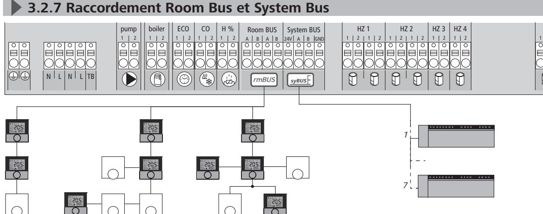
Selon le type de station de base, quatre, huit ou douze thermostats d'ambiance max. peuvent être raccordés sur le Room Bus. Le raccordement des thermostats peut s'effectuer dans les topologies en ligne, arborescence et étoile. Jusqu'à sept station de base peuvent être coupées via le System Bus. Utiliser un fil massif 2x2x08 pour le câblage. Prévoir un dispositif de décharge de traction côté montage pour un diamètre de câble < 6 mm.
