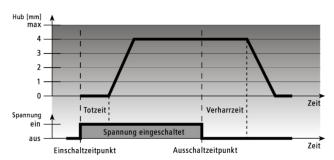
Bei der Ausführung stromlos-zu wird beim Einschalten der Betriebsspannung – nach Ablauf der Totzeit – das Ventil durch die Stößelbewegung gleichmäßig geöffnet.
