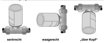
Der OEM-Antrieb ist bevorzugt in senkrechter oder waagerechter Montagelage einzubauen. Bei "über Kopf"-Montage können spezielle Umstände (z.B. Schmutzwasser) die Lebensdauer reduzieren.
