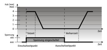
Bei der Ausführung stromlos-auf wird beim Einschalten der Betriebsspannung - nach Ablauf der Totzeit - das Ventil durch die Stößelbewegung gleichmäßig geschlossen.
