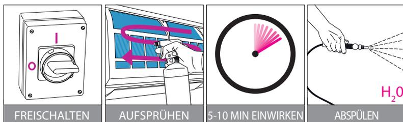
Anlage freischalten und elektrische Leitungen schützen. Reiniger mit einem Niederdrucksprüher in den Wärmetauscher sprühen. Anwendung in einer der oberen Ecken beginnen und dann systematisch seitlich und nach oben fortsetzen. Alle Oberflächen fünf bis zehn Minuten lang nass halten.
