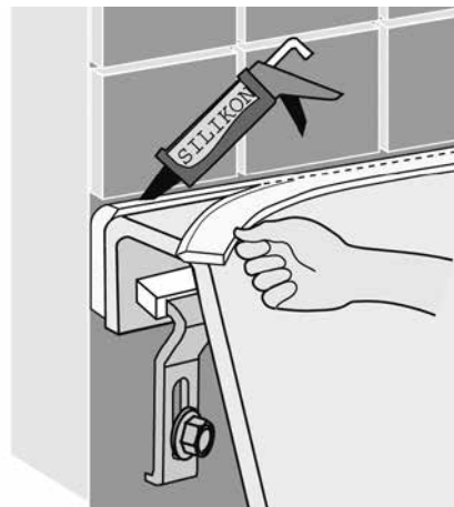
Abdichtung mit Wannendämmband und Silikonfuge
