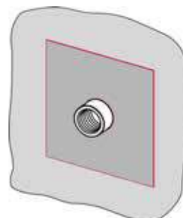
Bild 2: Dichtmanschette in noch feuchten Dichtanstrich einbetten
