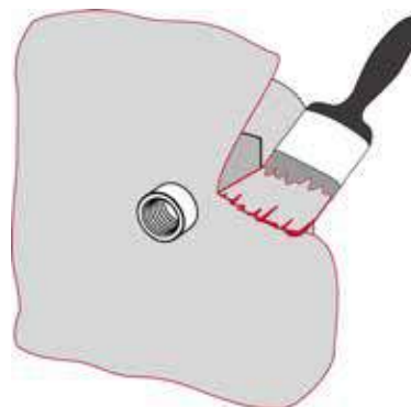
Bild 3: Aufbringen des oberen Dichtanstrichs
