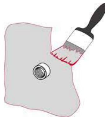
Bild 1: Aufbringen des unteren Dichtanstrichs
