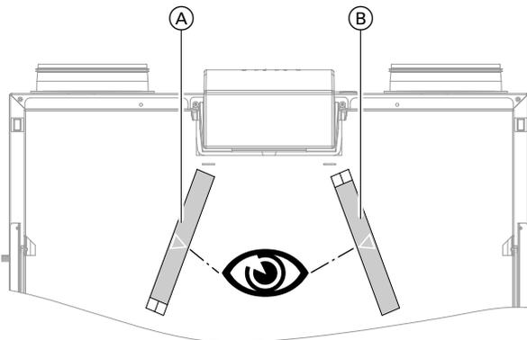
Abb. 22 Lage der Filterrahmen Typ HS32S A225
