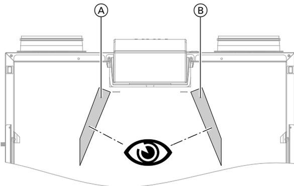
Abb. 24 Lage der Filterrahmen Typ HS32S A600
