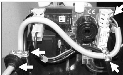
A riasztási csatlakozóvezetéket a hálózati vezetékkel párhuzamosan kell elvezetni a kondenzátszivattyú foglalatában. Ehhez az átvezetési tokon lévő második nyílást is meg kell nyitni.
