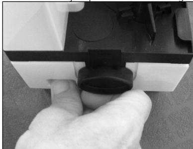
2. De vlotter en de condensaatbak reinigen.
