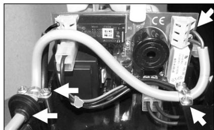
Alarmowy przewód przyłączeniowy wprowadzony jest do obudowy pompy kondensatu równolegle do przewodu sieciowego. W tym celu należy otworzyć drugi otwór w przepuscie kablowym.
